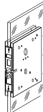
Avant de serrer définitivement, testez l'installation de la plaque frontale et des plaques de recouvrement pour vous assurer qu'elles sont alignées avec le verre et entre elles.
