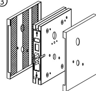
Retirer les plaques de recouvrement.
